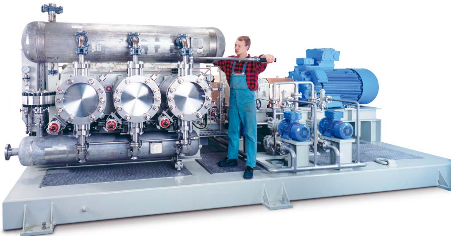
Пример химия: высокоррозионные промежуточные продукты G3 R, M 500, 14 м 3 /ч, 350 бар
