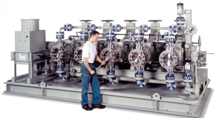
Пример химия / нефтехимия: впрыскивание метанола EG 5, M 500, 8,8 м 3 /ч при 345 бар
